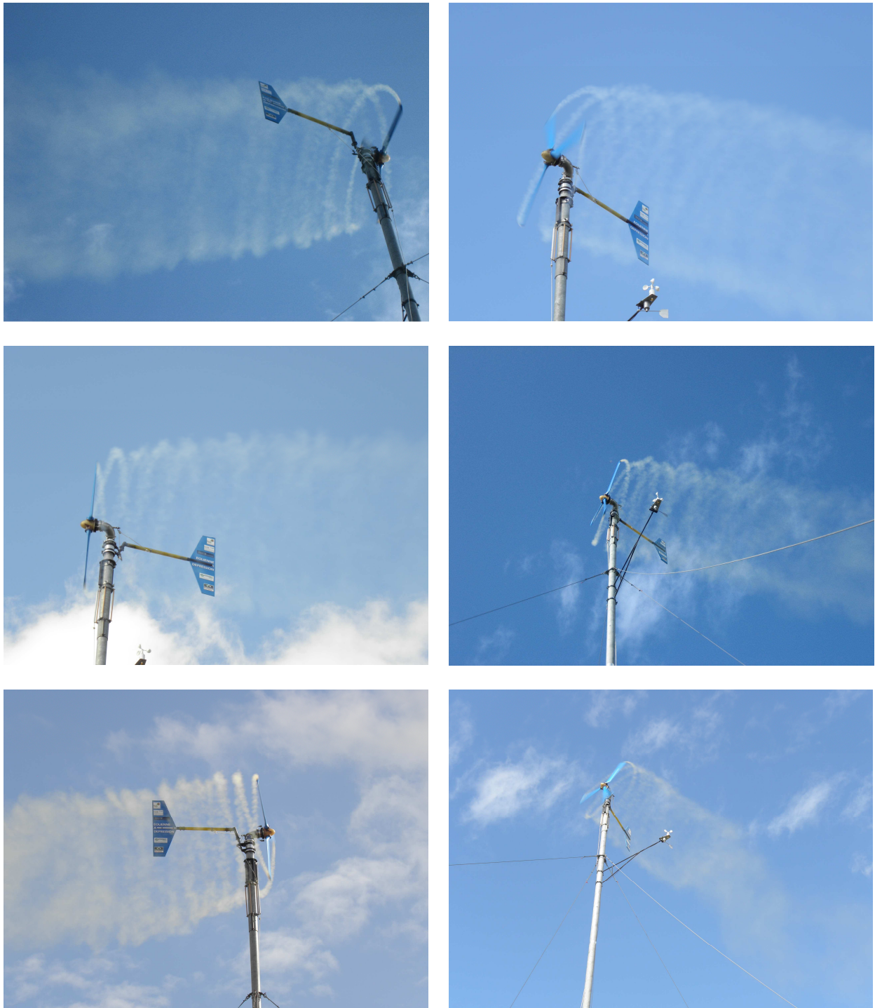
Figure 15 : Prises de vue du sillage grâce aux essais fumigène, avec des phases de vent à peu près stabilisées (essais du 20 juillet 2011, vent d'ouest). On remarque sur certaines photo une légère conicité avant que la turbulence ne reprenne le dessus.
